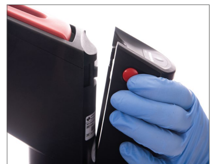
► Durch Drücken der beiden Entriegelungsknöpfe am Akku lässt sich dieser schnell und einfach auswechseln. Die Betriebsparameter bleiben dabei für 30 Sekunden erhalten.
