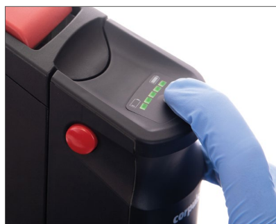
► Die Kontrollleuchten auf der LED Ladeanzeige geben einen schnellen Überblick über die Restkapazität des Akkus.
