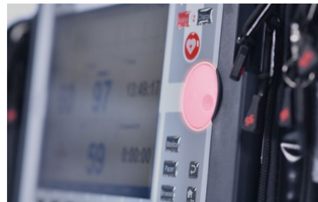
▲ Alarmvisualisierung durch leuchtendes Jog-Dial und Warntöne.
